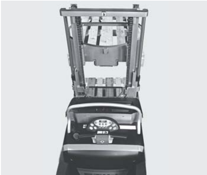
Hohe Umschlagleistung und beste Sicht auf die Last dank Freisichthubgerüst
