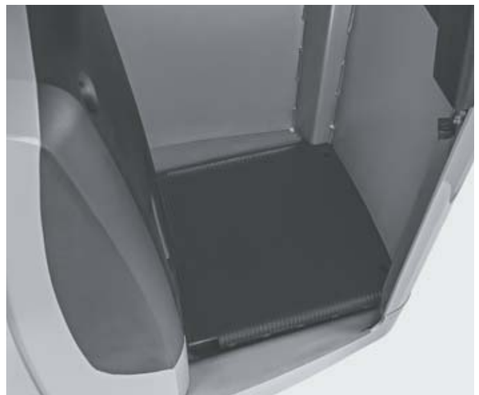
Conducción cómoda: la plataforma acolchada para el conductor mejora la capacidad de concentración
