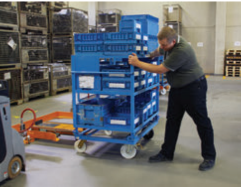
Bis zu 5 angehängte „E-Rahmen“ können je einen großen oder zwei kleine Kommissionier-Trolleys aufnehmen.
