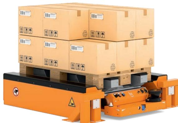
**Transporte de mercancías con palés:** En el transporte de mercancías con palés, el AXH iGo recoge el palé con la mercancía en una estación de transferencia determinada y lo transporta hasta su estación final. Antes de descargar en la estación final, el AXH comprueba si la estación de transferencia está libre para la descarga de la mercancía mediante la innovadora cámara 3D.
