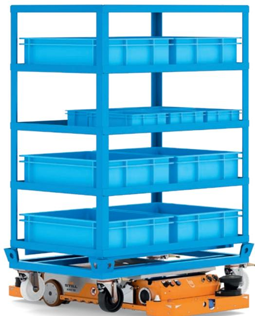
**Transporte de mercancías con jaula y sistema de estanterías ajustables:** Al transportar mercancías utilizando una jaula y un sistema de estanterías ajustables individualmente, las mercancías se cargan y transportan de forma flexible hasta su destino. En función de las necesidades del cliente, se pueden ofrecer opciones de transporte flexibles que también incorporen el uso de un carro.
