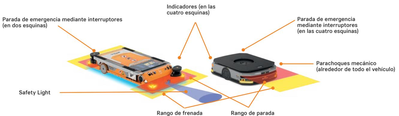
Gracias a un sistema de seguridad redundante de varios niveles, con el AXH iGo y el ACH iGo siempre estarás en el lado seguro. Los parachoques mecánicos evitan daños a los robots móviles autónomos, mientras que las áreas de seguridad definidas en el sentido de la marcha y alrededor del vehículo y el medio de transporte permiten frenar automáticamente para evitar colisiones.
