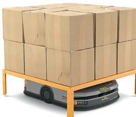
**Transporte de mercancías mediante plataforma de carga (tabla):** Cuando se transporta la mercancía a través de una plataforma de carga (tabla), el ACH iGo transporta toda la unidad de A hasta B. La mercancía se coloca en la plataforma de carga. El ACH iGo pasa por debajo del elemento, lo levanta, lo transporta a su destino y lo deposita allí. Si se utiliza un trolley transportador como portador de la mercancía, puede que se requieran medidas adicionales de posicionamiento.
