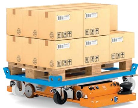
**Transporte de mercancías con carros:** En el transporte de mercancías mediante carros, el AXH iGo transporta la unidad completa de A a B. La innovadora cámara 3D garantiza una elevación flexible de la mercancía antes de cargarla en el AXH iGo, así como una descarga precisa en el destino deseado.
