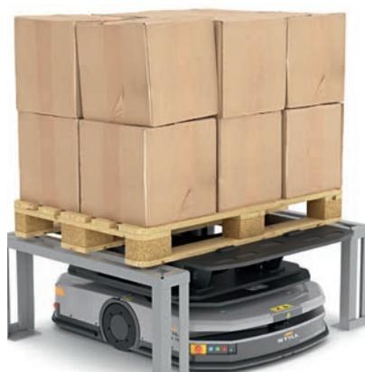
**Mercancías transportadas directamente en el vehículo:** Con el transporte directo de mercancías, el portador de las mercancías se traslada desde la estación de transferencia directamente al ACH iGo. El ACH iGo pasa por debajo de la estación cargada, levanta el palé con su placa adaptadora y la transporta al destino. La estación se rellena.
