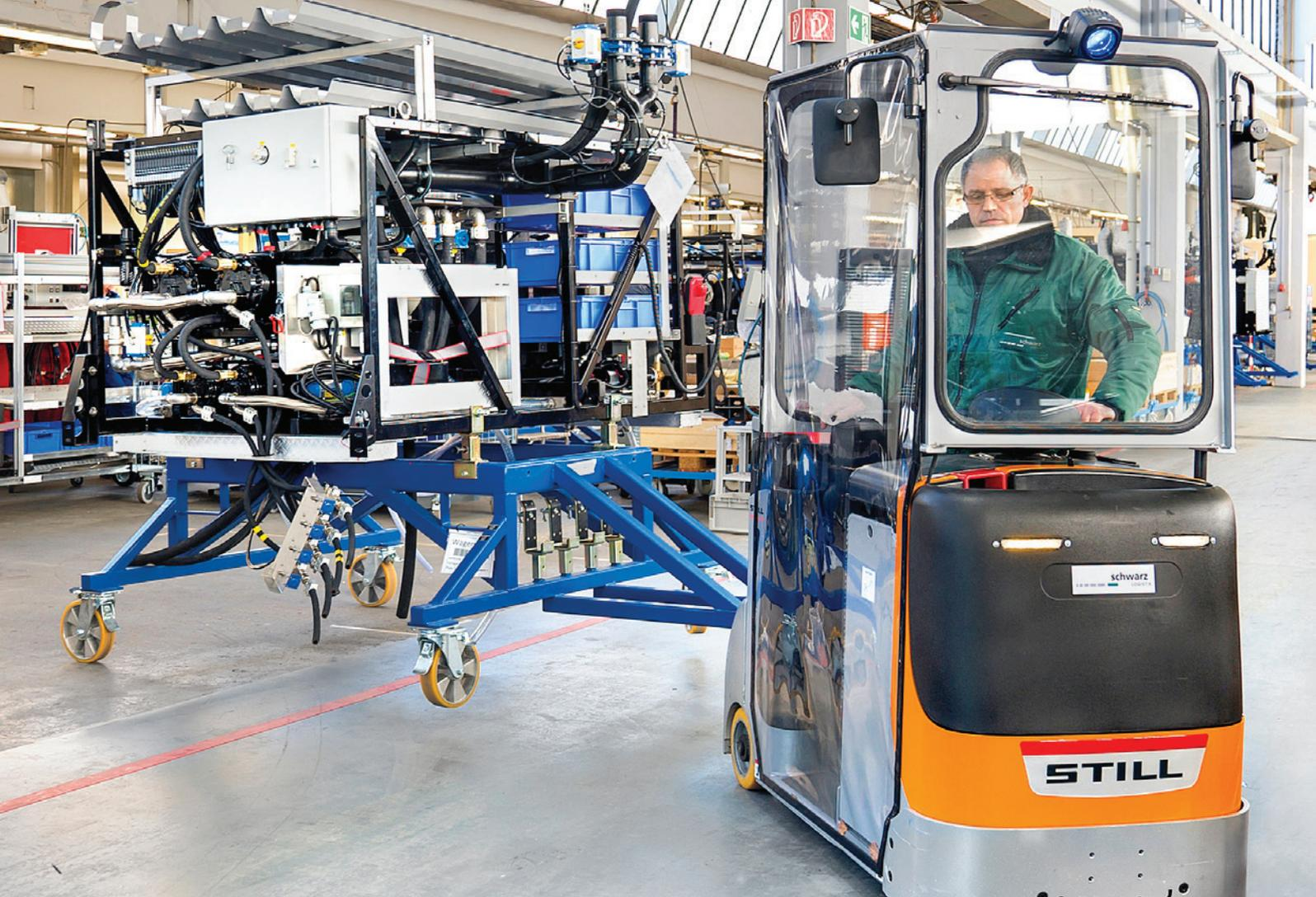
Einfach und komfortabel werden die Trolleys auf die Gabelzinken geschoben und mit der ergonomischen Fußmechanik gesichert.
