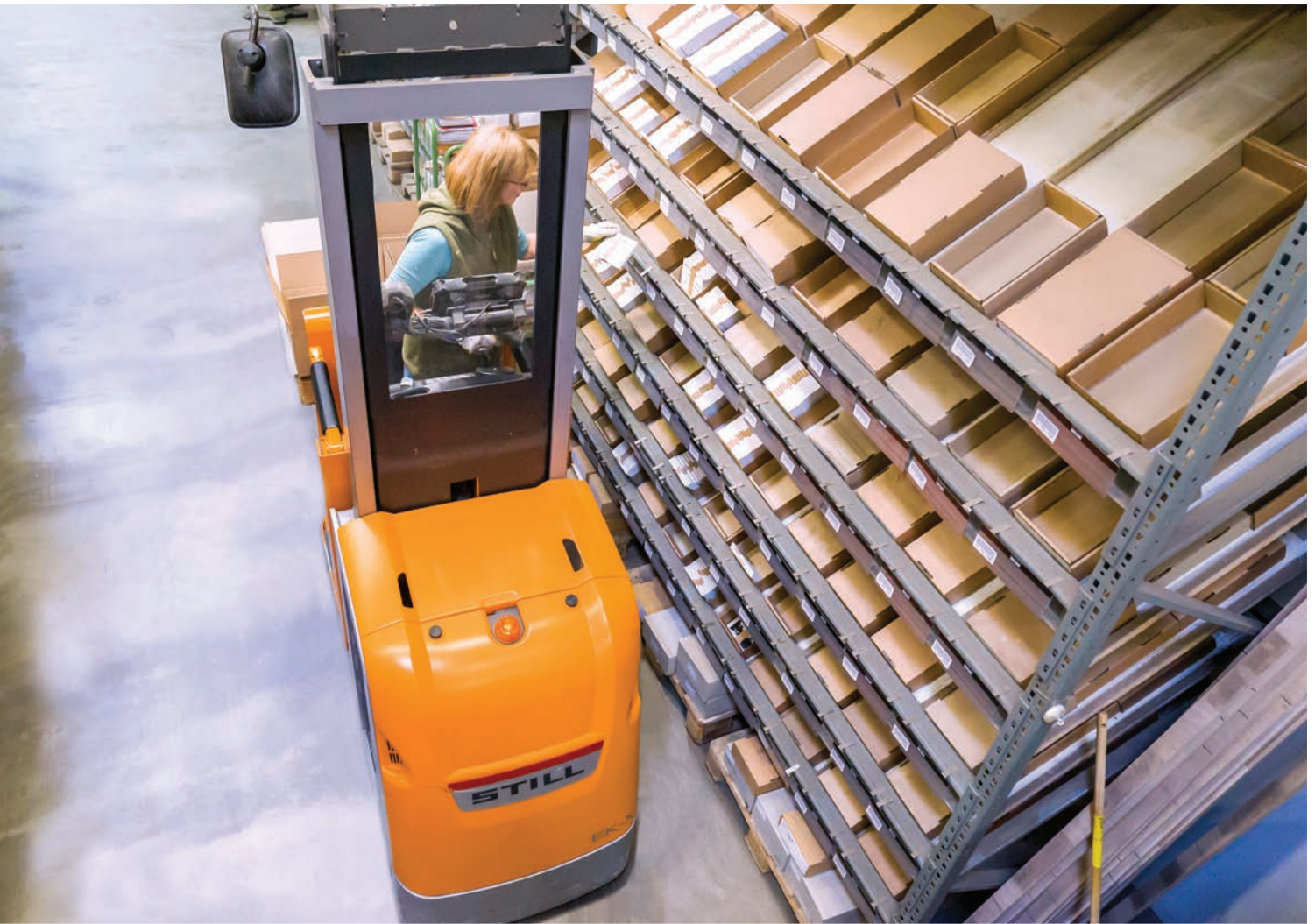
Hand in Hand werden mit zwei schmalen EK-X Vertikal-Kommissioniern von STILL Kleinteileartikel parallel zusammengestellt
