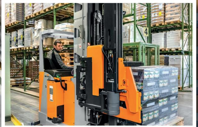
Mit der dreh- und wendbaren Schwenkschubgabel des NXV werden Vollpaletten komfortabel, schnell und sicher ein- und ausgelagert. Durch die geringen Maße kann nahezu jeder Platz im Hochregallager optimal genutzt werden.
