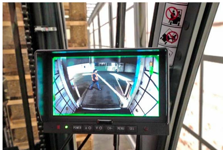
Außerhalb der Gefahrenzone wird bei Erkennen einer Person kein Alarm ausgelöst. Der Fahrer im STILL Stapler wird somit nur gewarnt, wenn es notwendig ist.
