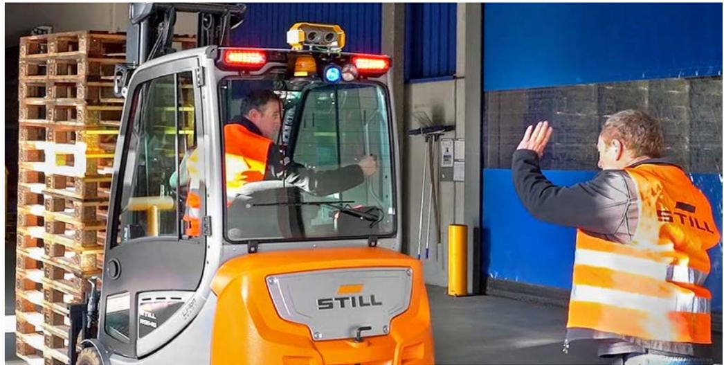
↑ Typische Unfallsituation: Eine Person betritt außerhalb des Sichtfelds des Fahrer bzw. der Fahrerin die Gefahrenzone. Droht eine Kollision mit einer Person, wird sogleich ein Alarm ausgelöst und die Fahrgeschwindigkeit auf Schleichfahrt reduziert.
