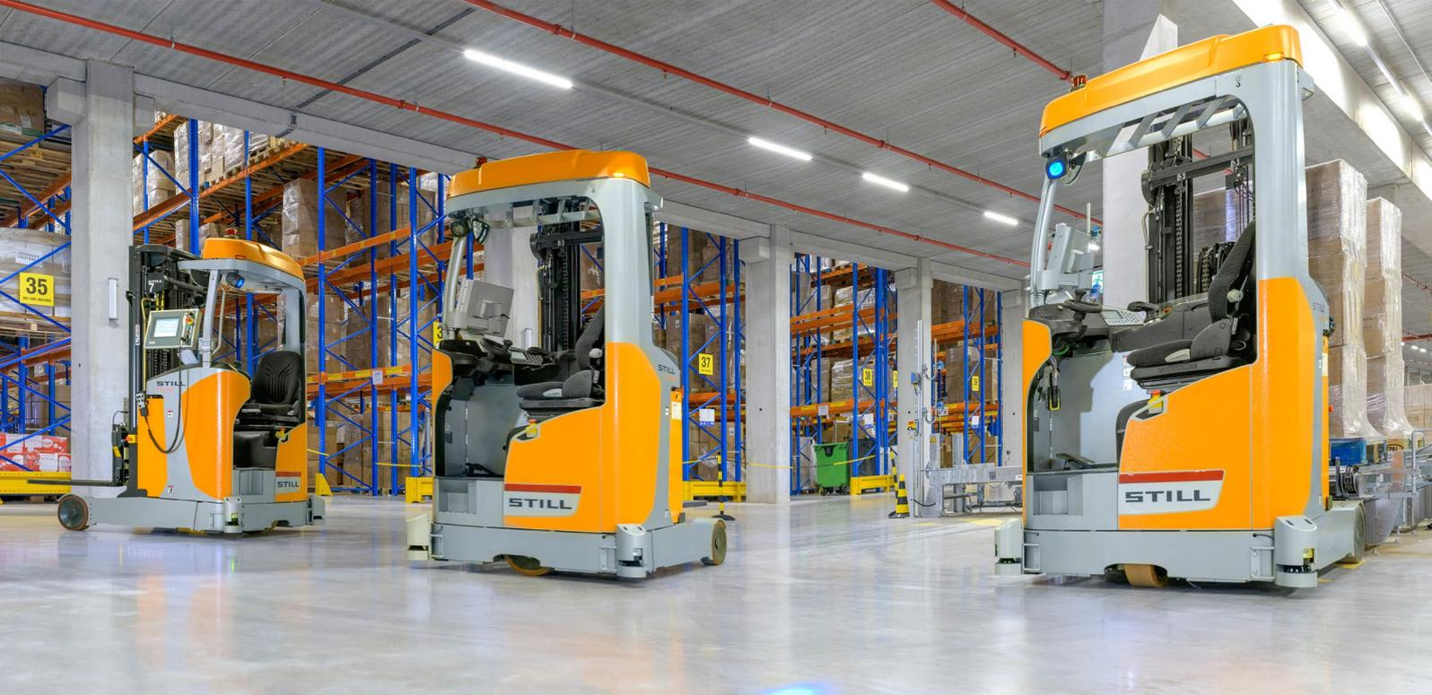
Sieben automatisierte FM-X Schubmaststapler transportieren die Paletten zum Pufferlager und lagern sie dort ein. Im 32-gassigen Pufferlager verkehren fünf automatisierte MX-X Schmalgangstapler (VNA) zum Ein- und Auslagerung der Paletten.
