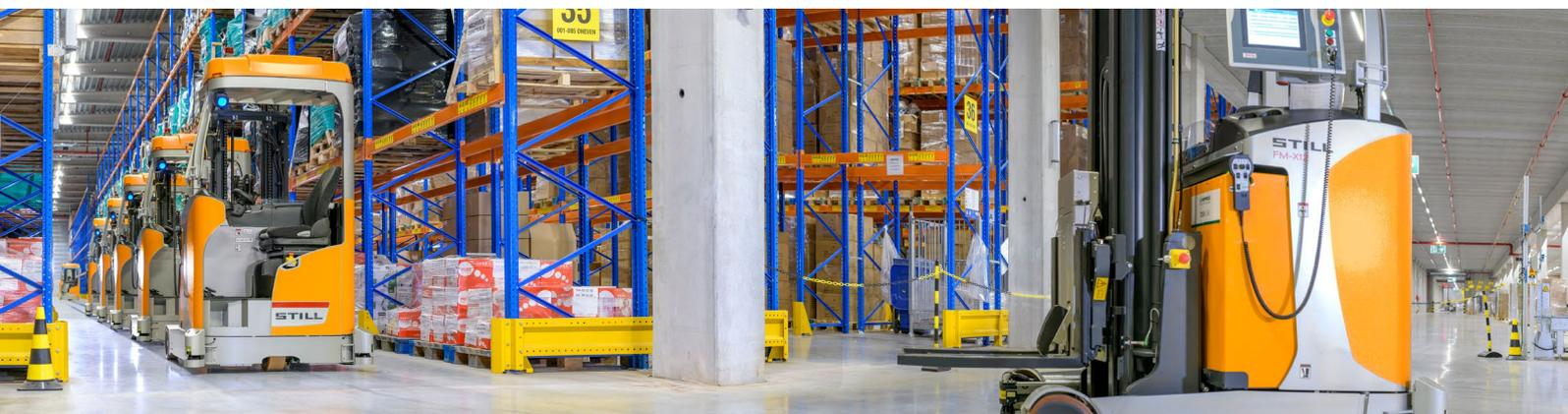
Das Aufladen der Akkus, einschließlich des zwischenzeitlichen Aufladens, verläuft ebenfalls vollautomatisch. Wenn ein Ladevorgang erforderlich oder wünschenswert ist, übermittelt das Steuerungssystem des Staplers dies und der Stapler fährt selbstständig zur Ladestation, wo der Akku über spezielle Kontaktpunkte auf- oder nachgeladen wird.
