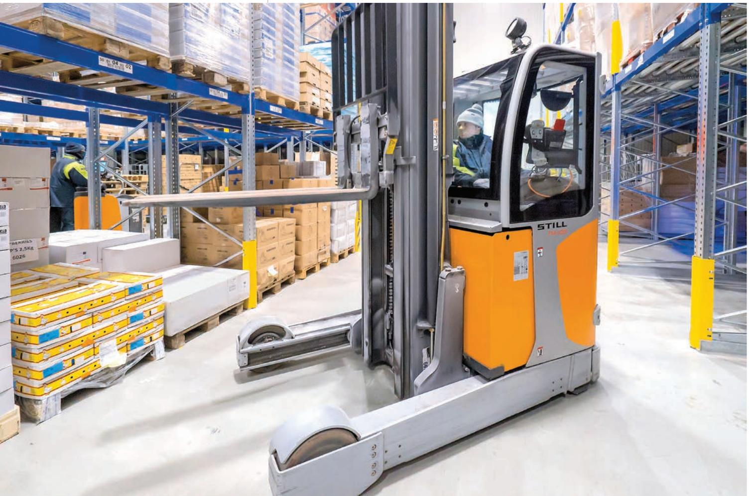
Mit Blick auf das bei Havi geführte Produktspektrum im Trocken-, Frische- und Tiefkühlsegment wurden alle FFZ von Still in der Tiefkühl-Ausführung für bis zu minus 30 Grad Celsius geliefert.
