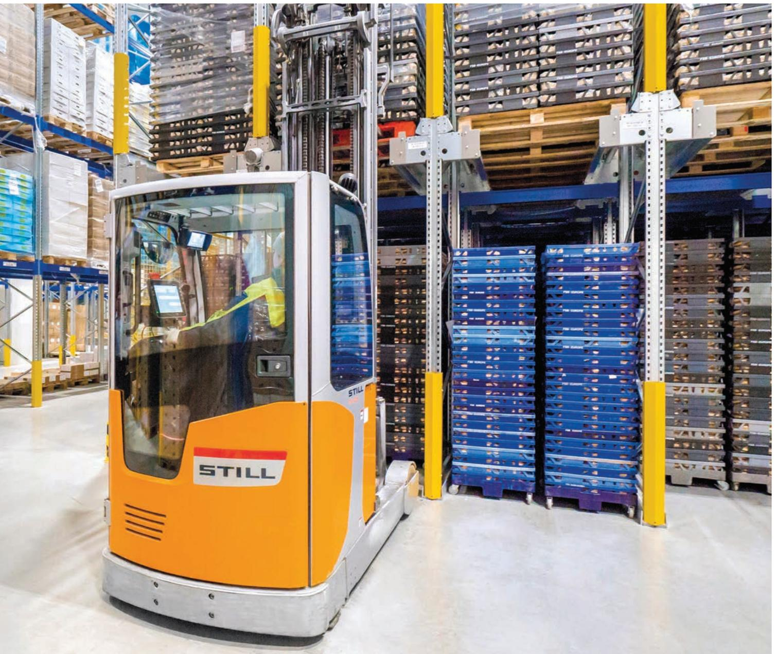
Alle Paletten lassen sich mit den verstellbaren Gabelzinken längs oder quer aufnehmen.
