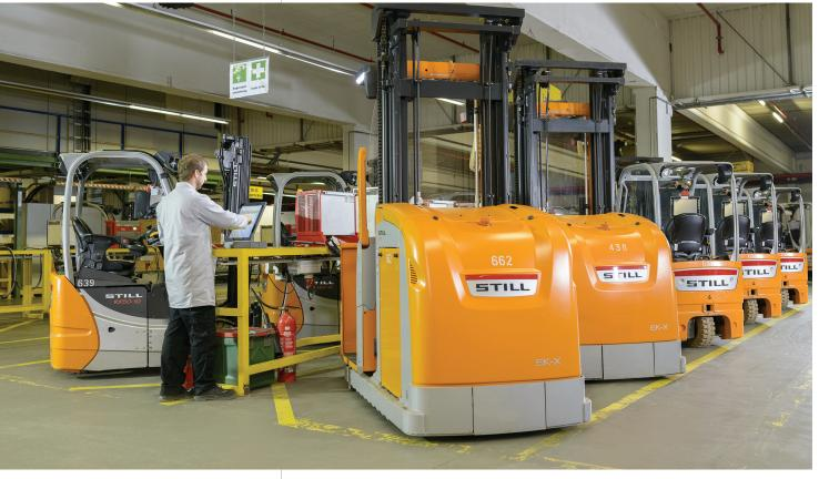
Durch Zutritt per OptiTruck ist jeder Fahrer auch identifiziert. Defekte oder Beschädigungen am Fahrzeug werden sofort bei der Rückgabe am Terminal gemeldet.
