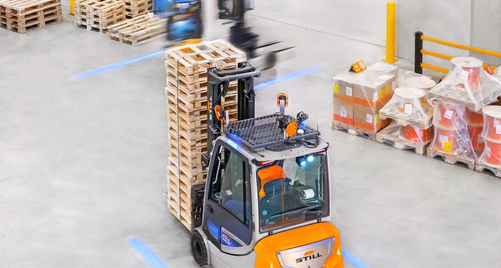
Die Fahrzeuge wurden mit einem funkbasierten Assistenzsystem zum Kollisionsschutz ausgerüstet. Zusätzlich warnt das Warnzonenlicht vor herannahenden Fahrzeugen.
