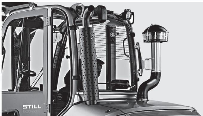
Filtre cyclonique purifiant l'admission d'air du moteur
