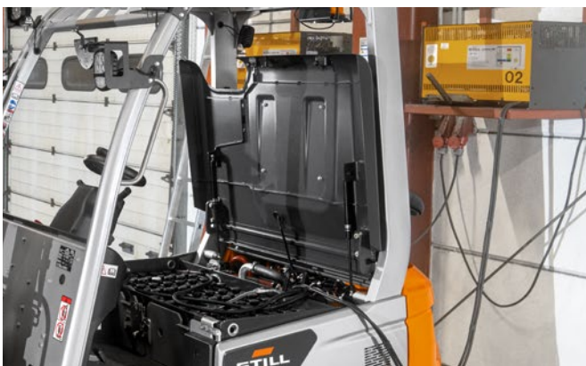
Graças ao sistema de carregamento compacto STILL, é possível fazer cargas de oportunidade da bateria.
