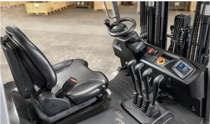
İyi fikir: STILL hidrolik palet elemanları, iş eldivenleri varken bile kullanımları kolay olacak şekilde düzenlenmiştir
