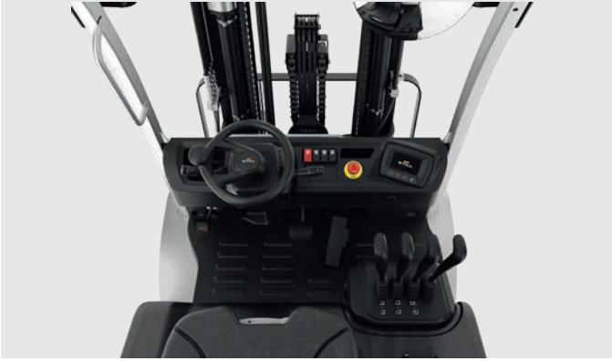
Esnek ve konforlu: Operatör koltuğu ve direksiyon simidi kademesiz ayarlanabilir, böylece kabin boyları farklı operatörler için hızlı ve kolay bir şekilde uyarlanabilir
