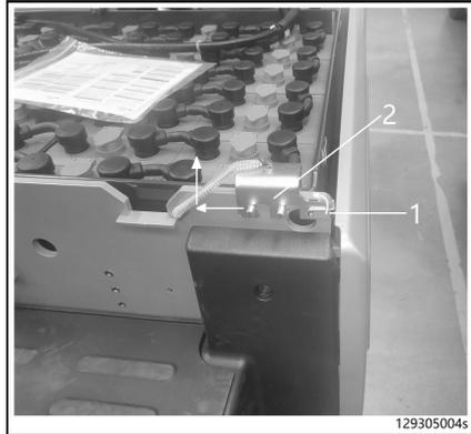
**Rimozione del perno di sicurezza**
