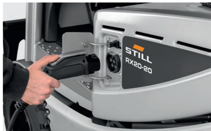
Opcionális beépített töltő: akkumulátorcseré nélküli helyfüggetlen töltés
