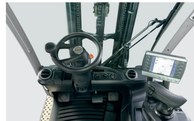
Vezetőfülke a kijelzővel, vezérlőegységekkel Joystick 4Plus rendszerrel és a fűtés kezelőszerveivel
