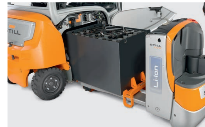
Akkutöltés az elektromos raklapszállítón
