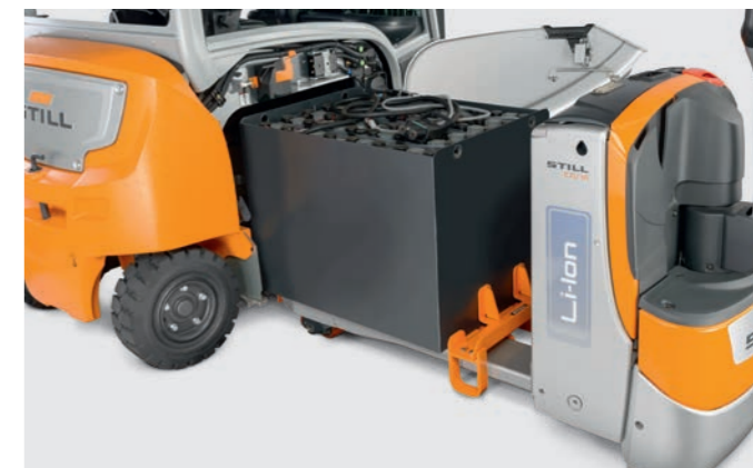
Batteribytte med elektrisk jekketralle
