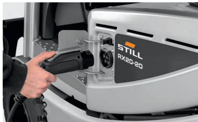
Opcjonalny wbudowany prostownik do zdecentralizowanego ładowania bez konieczności wymiany baterii
