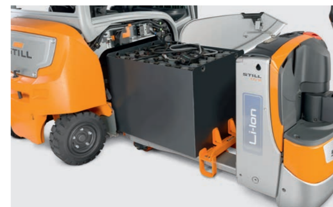
Łatwa i szybka wymiana baterii z użyciem elektrycznego wózka unoszącego
