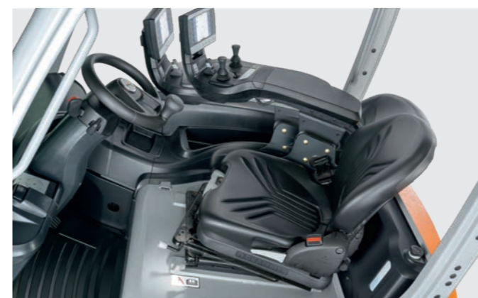
Obrotowy fotel zwiększa wygodę i bezpieczeństwo podczas jazdy do tyłu
