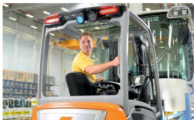
Obrotowy fotel oraz tylni uchwyt, który można wyposażyć w klakson zapewniając bezpieczną i ergonomiczną jazdę do tyłu
