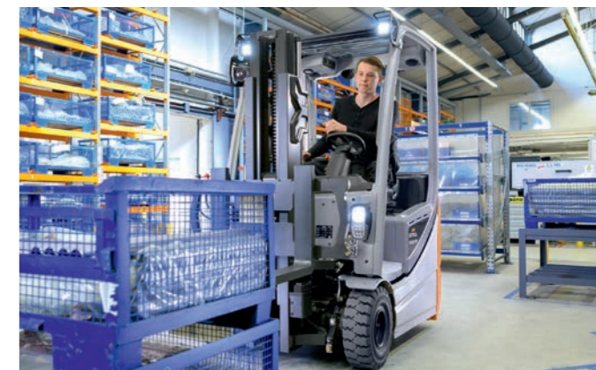
Szybka i bezpieczna praca dzięki doskonałej widoczności przez maszt Easy View
