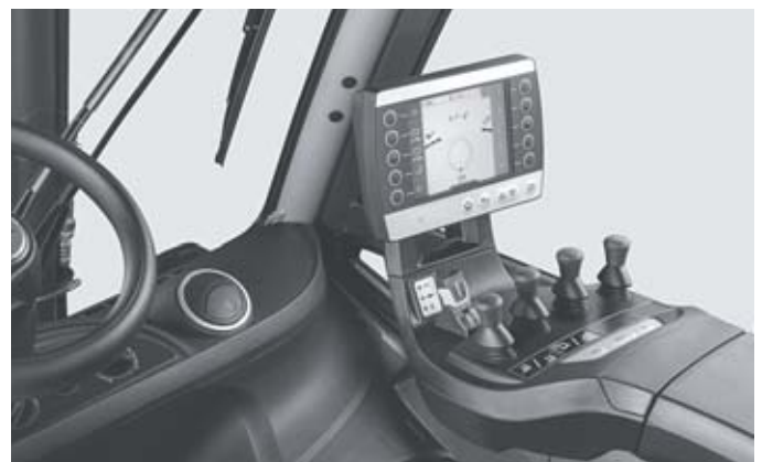
Turvallinen ja intuitiivinen käyttö STILL Easy Control -näytöllä ja ohjausmoduulilla
