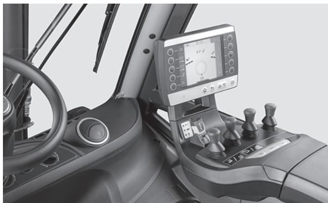
Pilotage intuitif et sans risque d'erreur grâce au module combiné de commande et d'affichage STILL Easy Control
