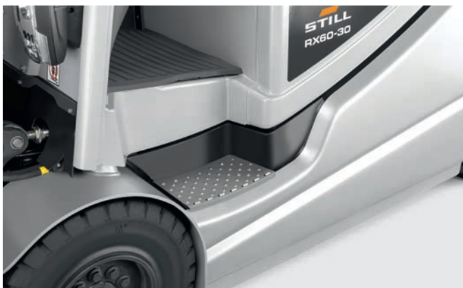
Vysoká úroveň bezpečnosti vďaka veľkým schodom s protišmykovou úpravou umožňujúcim ľahký prístup
