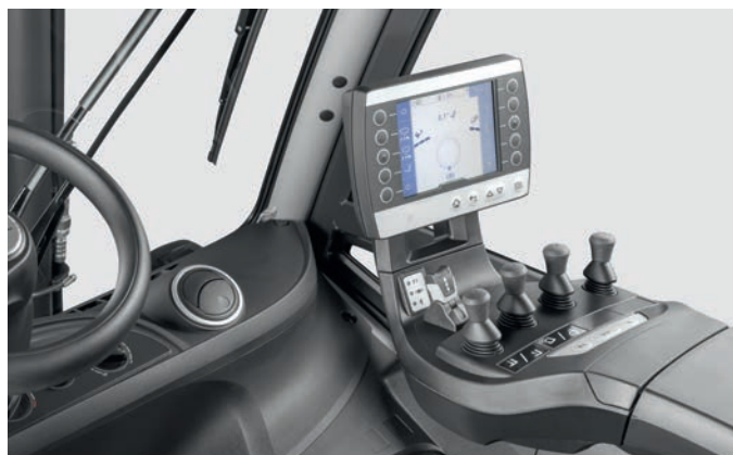
Bezpečná a intuitívna prevádzka s použitím zobrazovacieho a ovládacieho modulu STILL Easy Control
