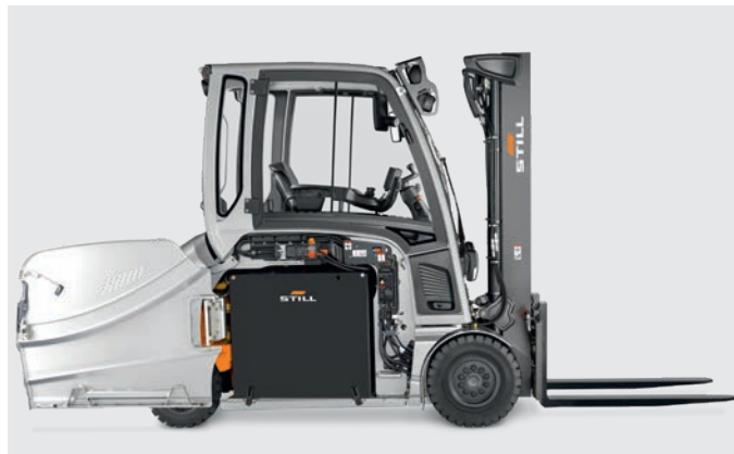
Optimálna dostupnosť vďaka rýchlej a bezpečnej výmene batérie
