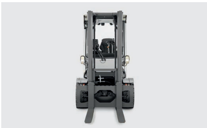
Wąskie profile masztu gwarantujące doskonałą widoczność na widły oraz bardzo wysoki poziom bezpieczeństwa
