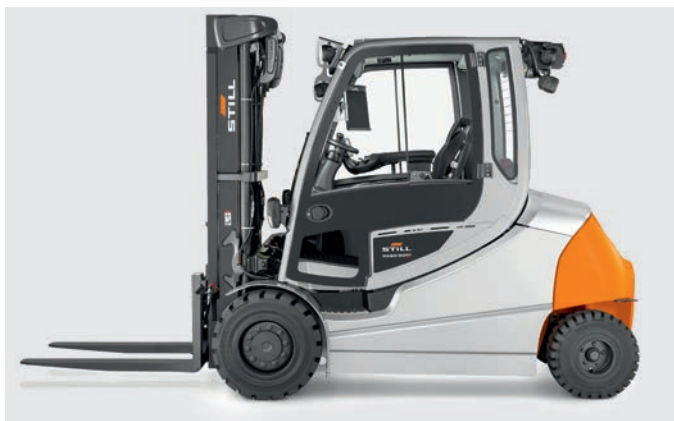
Pełna kabina do użytku zewnętrznego w każdych warunkach atmosferycznych
