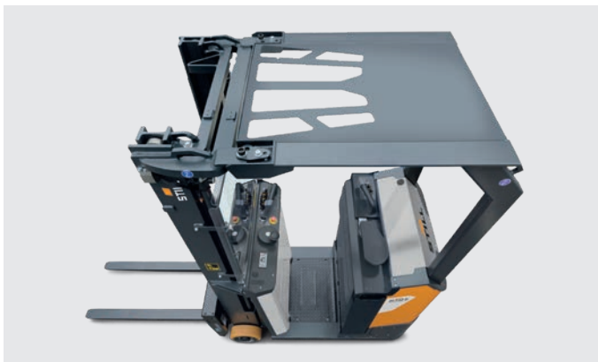
Robustná ochranná strieška s ocelovými vzperami pre optimalizáciu viditeľnosti a zvýšenie bezpečnosti 3
