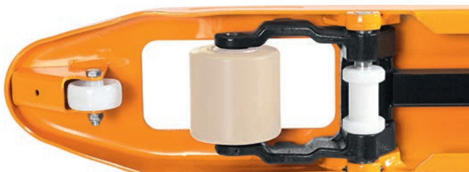
Direction souple et légère, faible résistance au roulement (galet simple en Nylon)
