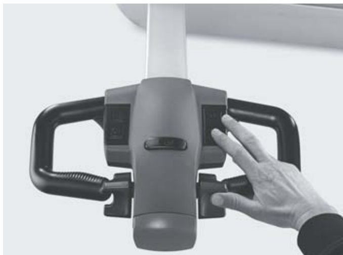
Rukojeť ovládací oje optimalizovaná pro leváky i praváky zajišťuje neunavující práci
