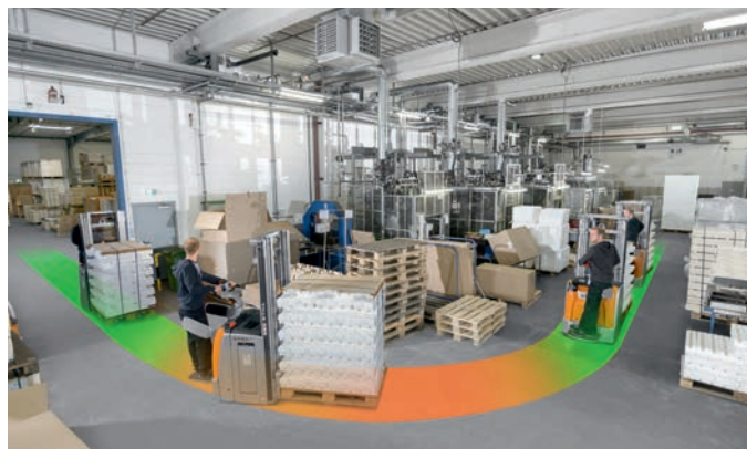
Kom sikkert rundt i svingene: Automatisk hastighedsregulering ved kurvekørsel
