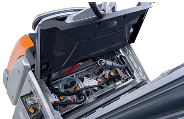
Hurtig og sikker: Det innovative batterilæg gør det muligt hurtigt at skifte batteri uden risiko for at komme i klemme
