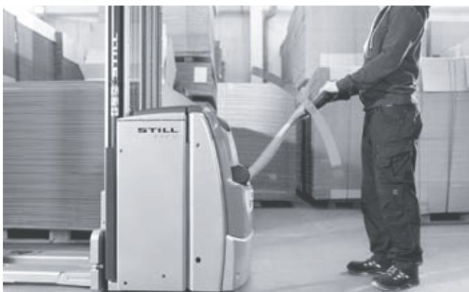
Sériově dodávaná bezpečnost: rychlost jízdy se v závislosti na úhlu ovládací oje automaticky přizpůsobí vzdálenosti obsluhy od vozíku
