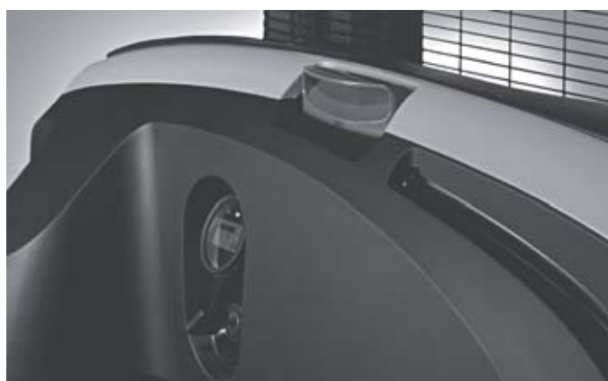
Neoprávněný přístup je vyloučen: kontrola přístupu k vozíku prostřednictvím klíče, PIN kódu, čipu nebo karty
