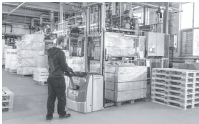
Vysoký výkon překládky díky současné přepravě dvou nákladových jednotek, které nelze stohovat
