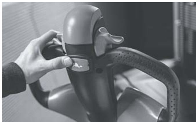
Precizní v každé situaci: díky spínači mikrojezdu je možné manévrování i v nejtěsnějších prostorech
