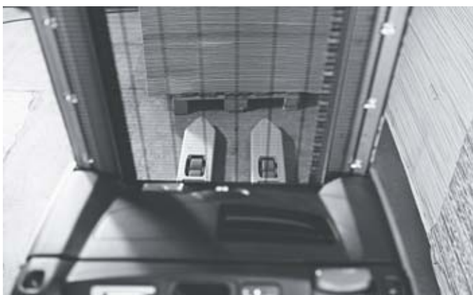
Vynikající výhled na hroty vidlic díky zvedacímu zařízení STILL s volným výhledem
