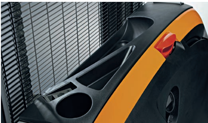
Freie Hände: Praktische Ablagefächer und eine Schreibunterlage mit integrierter Papierklemme
