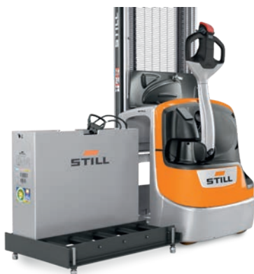
Höchste Fahrzeugverfügbarkeit durch einfachen, seitlichen Batteriewechsel beim EXV 14 C (optional)
