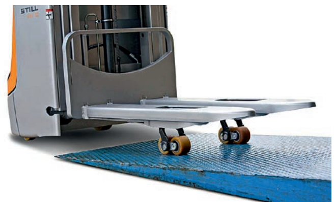
Einfaches Überwinden von Steigungen Dank des optionalen Initialhubs
