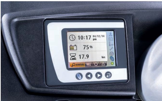
Visibilité toujours optimale : écran couleur regroupant d'un coup d'oeil, sous forme de symboles universels, toutes les fonctions importantes
