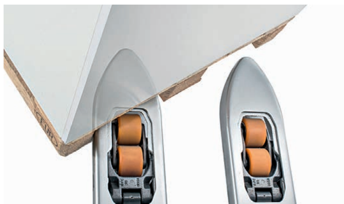
Lätt att skjuta in i pallar: Snabbt och exakt arbete med avrundade gafflar
