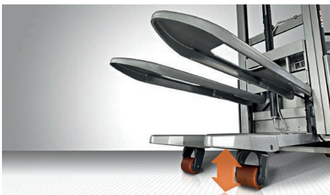
Större markfrigång för ojämna golv tack vare initiallyft (tillval)
