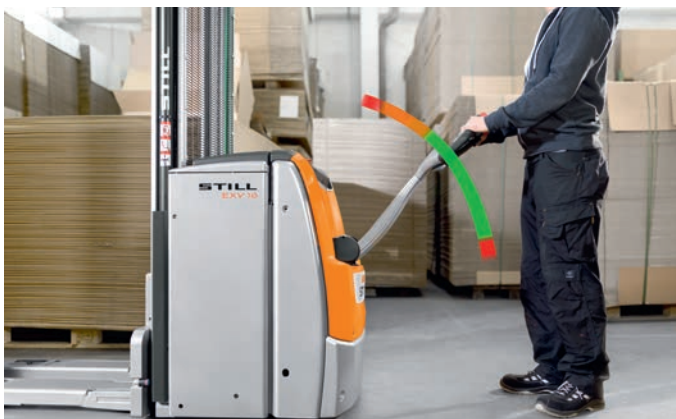
Säkerhet i serie: Hastigheten anpassas automatiskt utifrån förarens avstånd från fordonet beroende på styrarmens vinkel
