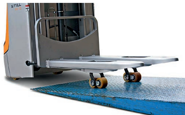
Du tar dig enkelt över lutande plan tack vare initiallyften
