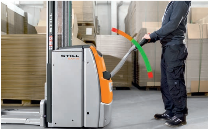
Sikkerhet i produksjonen: hastigheten tilpasser seg avstanden mellom føreren og trucken avhengig av kjørehåndtakets vinkel
