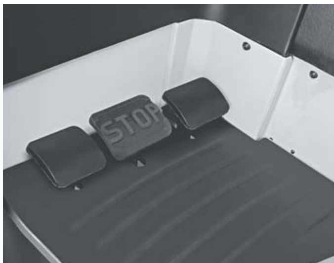
Rapidité et précision au doigt (de pied) et à l'œil grâce au pédalier de changement de direction
