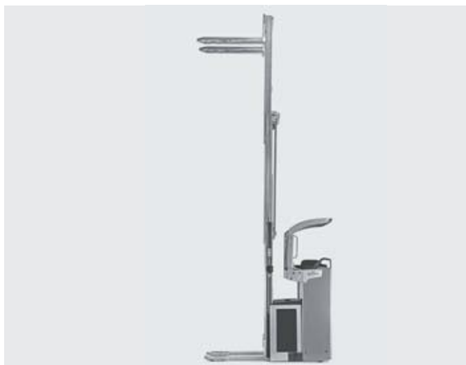
Wysoka wydajność przetadunkowa: udźwieg do 1600 kg i wysokości podnoszenia do 6216 mm
