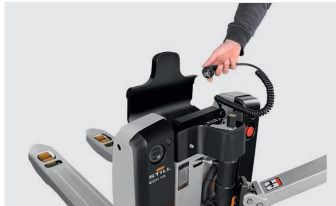
Vždy připraven: integrovaná nabíječka s technologií Li-Ion umožňuje pohodlné průběžné nabíjení
