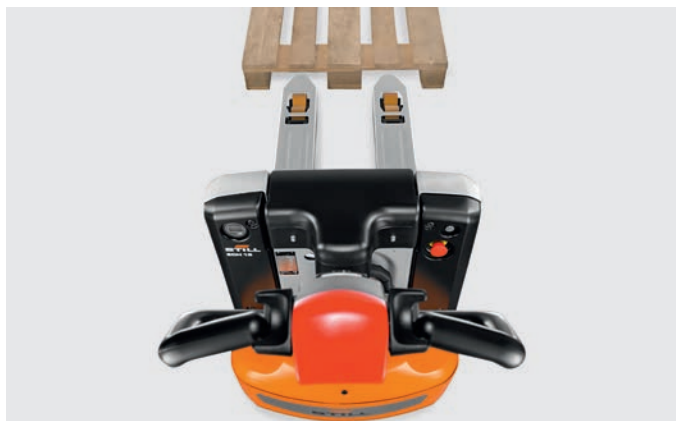
La compacité du transpalette permet une meilleure visibilité sur les fourches
