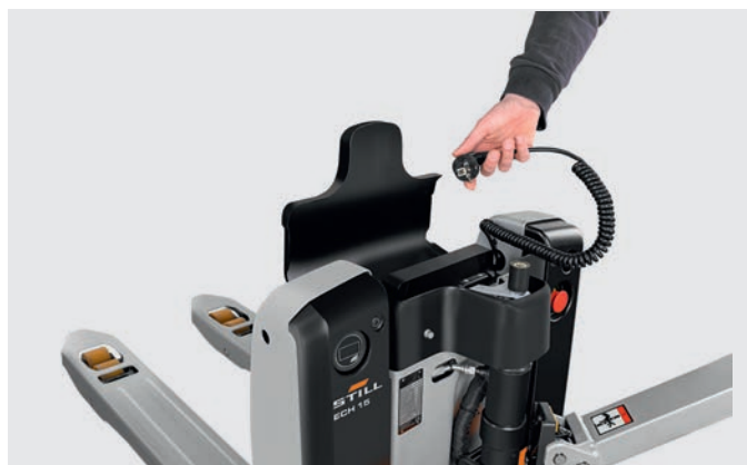
Stała dostępność: wbudowana ładowarka dla technologii litowo-jonowej pozwala na pośrednie i szybkie doładowania
