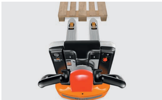
Mała wysokość wózka zapewnia dobrą widoczność końcówek wideł
