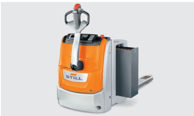
Der EXH 25-30 ist immer verfügbar mit Lithium-Ionen-Technologie und Batteriekapazitäten bis zu 500 Ah
