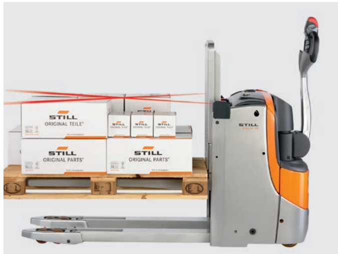
Kiváló ergonómia az autolift funkcióval, a villák automatikus emelésével és süllyesztésével
