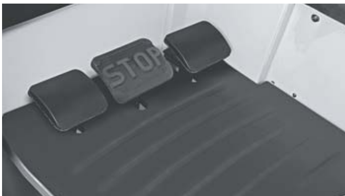
Précision à la pointe des pieds : version double pédales pour des changements rapides de sens de marche
