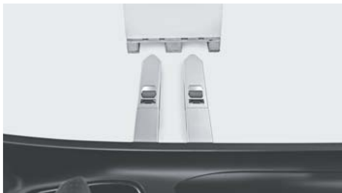
Vue optimale sur les pointes de fourche pour une meilleure efficacité
