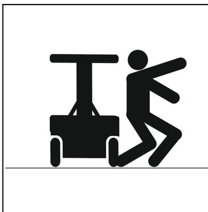
I pedoni hanno sempre la precedenza. Non possono controllare il tuo veicolo. Avviare l'unità lentamente e non guidare mai troppo vicino ad essi. Fare attenzione agli incroci. Controllare l'area intorno al veicolo e sotto la piattaforma prima di procedere con l'abbassamento o la guida.
