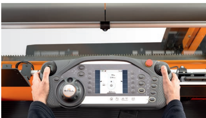
Kompaktní a ergonomický ovládací pult s barevným displejem a pokyny pro řidiče
