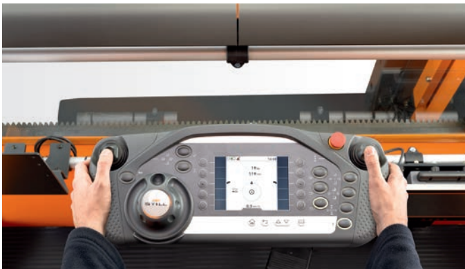
Panel de manejo compacto y ergonómico con pantalla en color e indicaciones para el conductor
