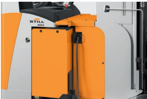
Option d'accès pour la charge d'opportunité des batteries lithium-ion
