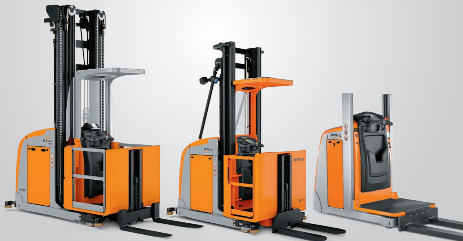
PXV: Triplex-mast, når høyder opptil 14,5 meter
