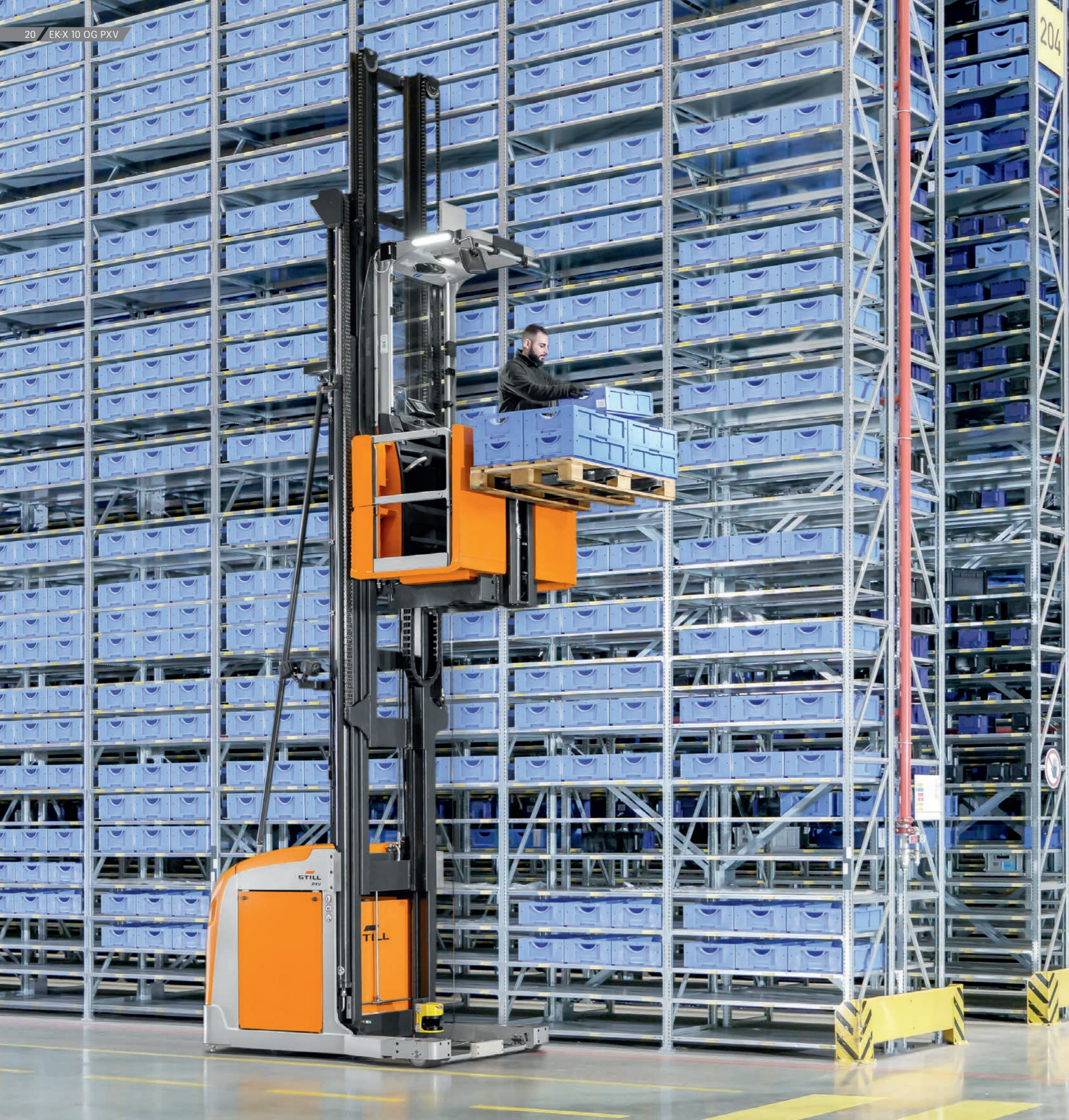
PXV vertikal ordreplukker med teleskopmast opp til 1.200 kg, når høyder opp til 14,5 meter
