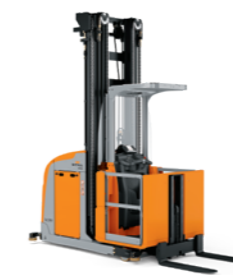
PXV vertikal ordreplukker med teleskopmast opp til 1.200 kg, når høyder opp til 14,5 meter
