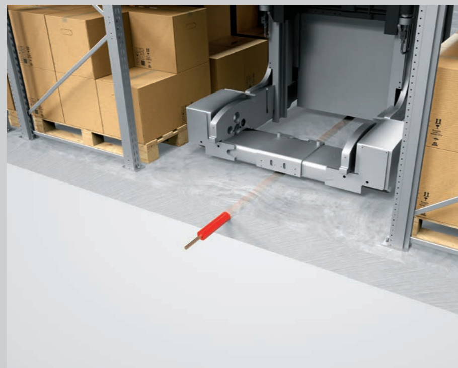
Induktivt styringssystem (styrewire på gulvet)
