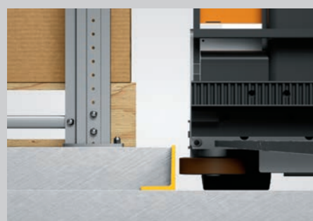
Mekanisk tvunget styring, høyde 100 mm (gaffelblad)
