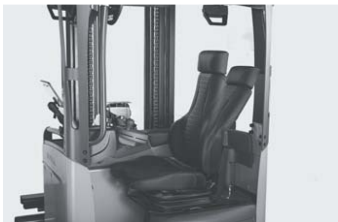
Le siège inclinable offre un grand confort et une excellente visibilité en hauteur
