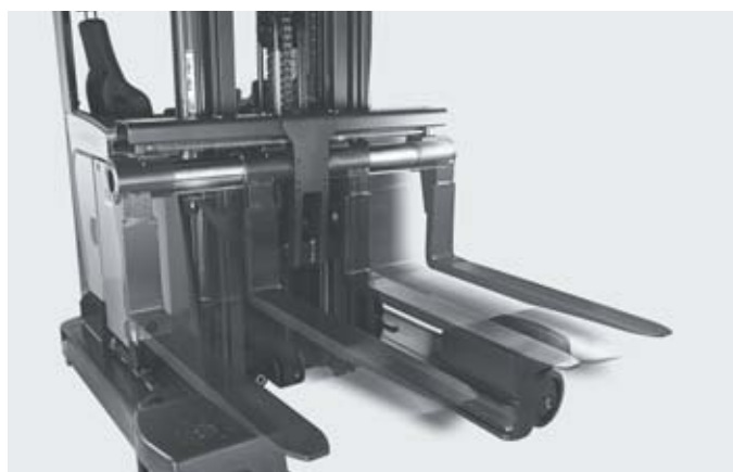
Le système de propagation des bras de fourche hydrauliques facilite la manutention des charges
