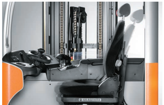
Comoda visibilidad hacia arriba y hacia las cargas gracias al exclusivo asiento inclinable
