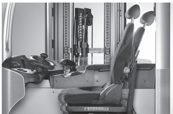
Le siège inclinable permet une visibilité constante sur la charge
