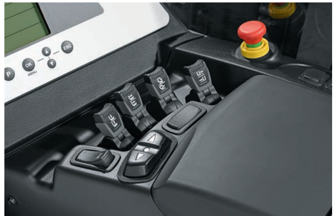
Összes funkció egyszerű kezelése fogásváltás nélkül, Fingertip vezérléssel
