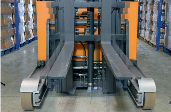
Rakomány optimális láthatósága az egyedi, oldalirányban eltolható emelőoszlop révén
