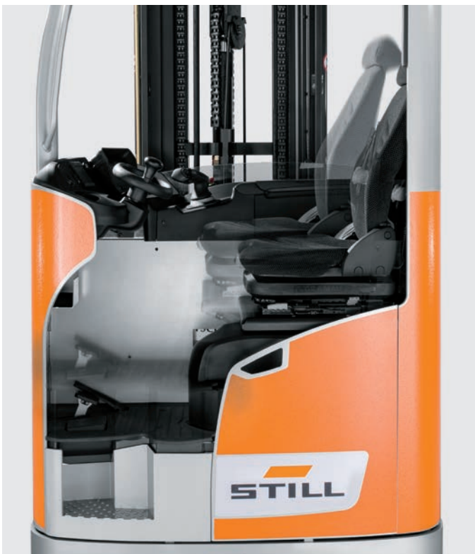
Ergonomisk posisjon på grunn av proporsjonelt sete og fotplatejustering
