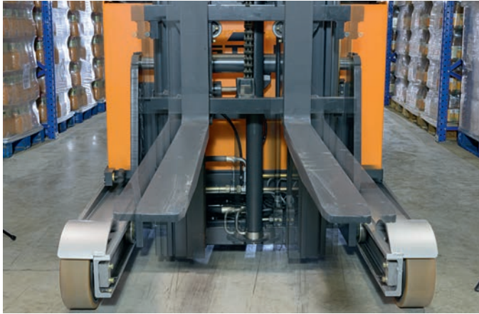
God utsikt over varene på grunn av unik sideforskyvermast
